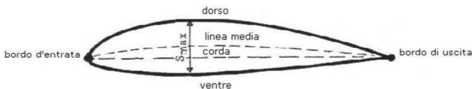
Figura 2.3: Elementi caratteristici di un profilo alare
